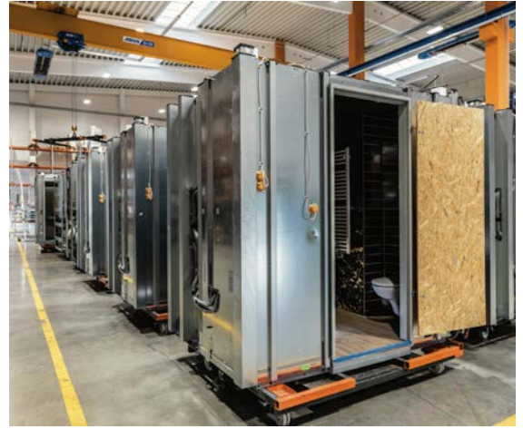
Abb. 11 Bei der Vorfertigung der Nasszellen ist die Reduktion von Gewerkeschnittstellen auf der Baustelle vorteilhaft. [© Stengel GmbH]
