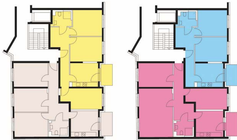
Abb. 5 Chemnitz: Aktueller Grundrissausschnitt und mögliche alternative Grundrissvariante (rechts). Vorbereitete Durchbrüche erleichtern zukünftige Umbauten. Nicht veränderliche Wandanteile sind schwarz ausgefüllt. [© BF Vario]
