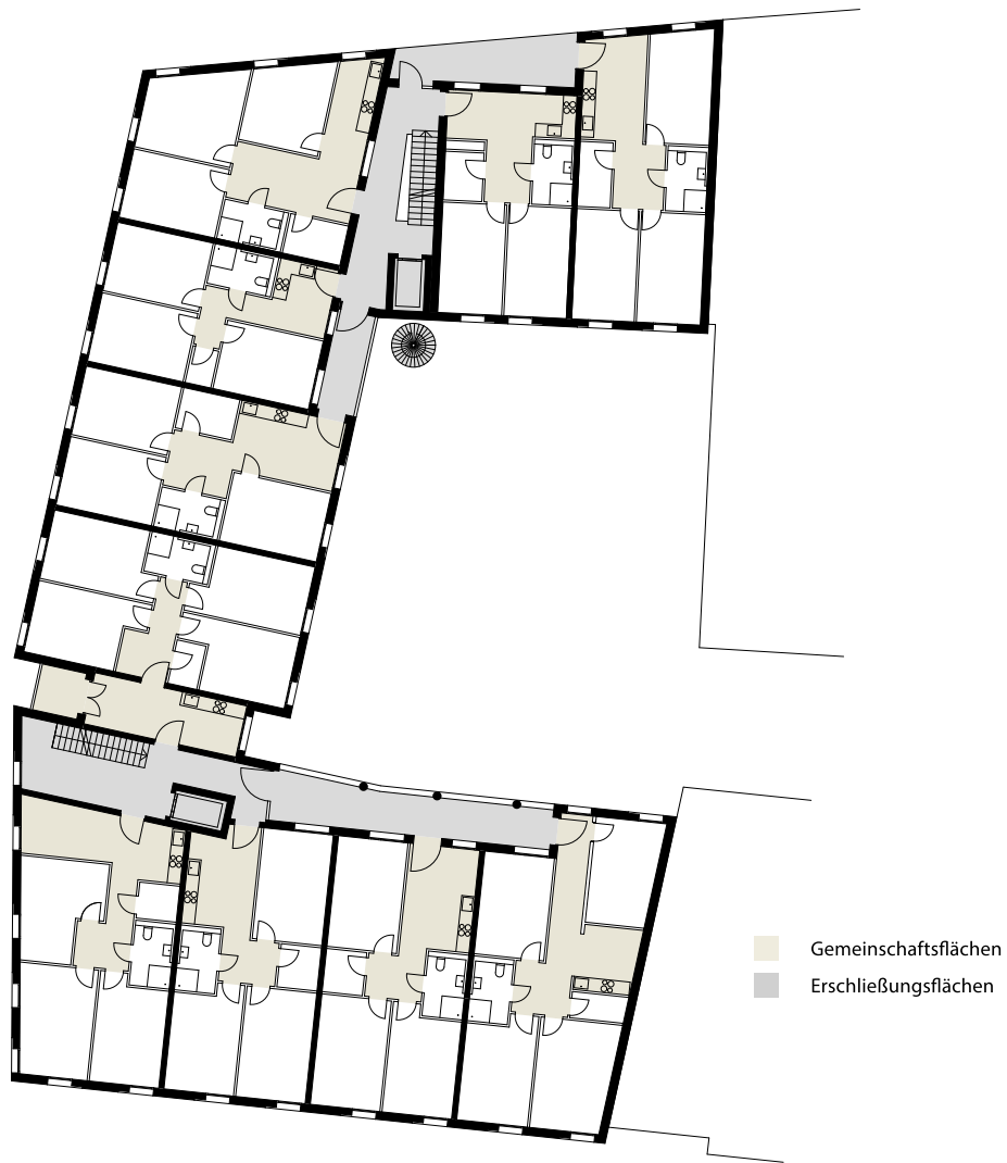
Abb. 163 Grundriss Regelgeschoss, M. 1:375 [© BF Vario]
